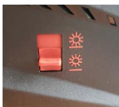
11 - Positionnez l'interrupteur en **mode transport**.
