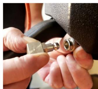
7- 1 Déconnectez la sortie de réservoir munie d'un clapet.
